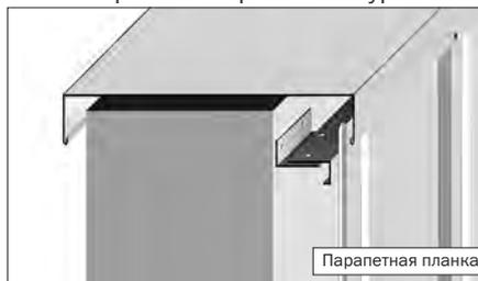
Парапетная планка закрывает как торец парапета, так и щель между стеной и облицовкой из профлиста, и поэтому накрывает его снаружи. Показанная форма является самой простой. В реальной ситуации парапетная планка может быть более сложной конфигурации или состоять из нескольких частей.
