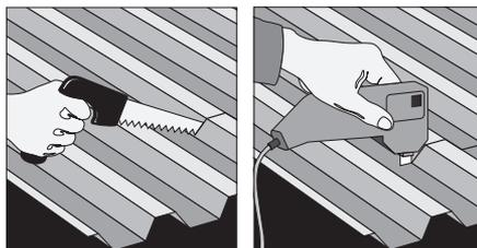
лей на строительной площадке. Для обрезки профилей оптимальны вырубные механические ножницы, но также применяют и обыкновенные ножницы для жести, тонкозубую ножовку или твердосплавную дисковую электропилу. Пользоваться абразивным инструментом нельзя!
