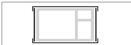
затем устанавливаются боковые планки, которые закрывают эти отгибы. Таким образом, получается коробочка, в щели которой не затекает вода. Выходящие на фасад плоскости спецпланок прирезают по месту друг к другу под углом 45°.
