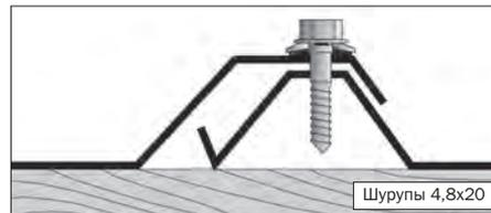
При продольном нахлесте профлист скрепляется друг с другом самонарезающими шурупами (SL-2) по гребню волны с шагом не более 500 мм.
