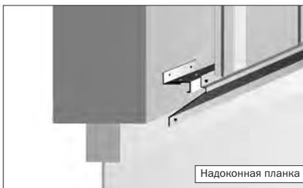
Надоконная планка служит элементом оформления оконного (дверного) проема. Данная конфигурация обусловлена необходимостью отвода воды, стекающей (при осадках) с профлиста, а также закрытия щели, образовавшейся между стеной и профлистом. Верхняя часть планки заводится под профлист, нижняя крепится к оконному (дверному) блоку.
