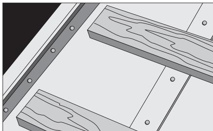
По стропилам на подкладку необходимо крепить планку (доску), которая предотвращает повреждение подкладки шурупами, при креплении кровельных профилей. Край подкладки, шириной около 30 мм, заворачивают наверх и прибивают к внутреннему краю торцевой доски. При резке подкладочного материала применяют обыкновенный нож и прямую рейку.
