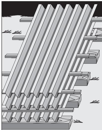
При длительности хранения более одного месяца, штабели оцинкованных профилей без полимерного покрытия следует расположить под навесом либо в сухом проветриваемом помещении.
