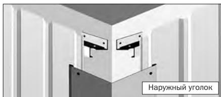
Функции наружного и внутреннего уголка очевидны — скрытие щелей при переходе одной вертикальной плоскости фасада в другую. Угол сгиба в большинстве случаев 90°.
