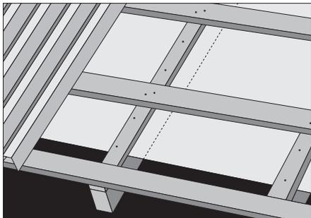
Цель подкладки (гидробарьера) — предотвратить накопление конденсата и проникновение его в верхний теплоизоляционный слой. Между подкладкой и первой доской обрешетки у свеса должна оставаться щель шириной около 50 мм для вентиляции. Гидробарьер к обрешетке прибивают большеголовыми короткими (мин. 25 мм) гвоздями с шагом около 20 см.
